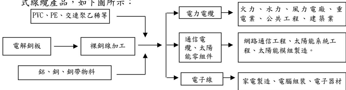
我國電線電纜產業係以中小企業為主，主要產品種類可區分為銅、鋁線材類、電力電纜類、通信電纜類、電子線類及漆包線等，經過多年來生產技術及設備工程能力的提昇，電線電纜已趨向於成熟性產品。我國電線電纜產業結構如表(1)所示，自上游主要原料如銅材、鋁材冶煉、裸光纖絲抽絲及各種絕緣料或外被料供應，中游之各種規格種類的電線電纜依不同的生產流程加工製造，及下游之電力、通信及家電、電子等產業運用，已成立一個完整的產業體系。
